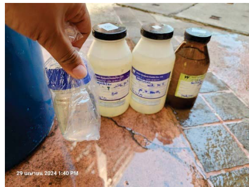
ภาพที่ 3.5.3-1 จุดการเก็บตัวอย่างน้ำทิ้งบ่อพักน้ำสุดท้ายก่อนระบายออกนอก
